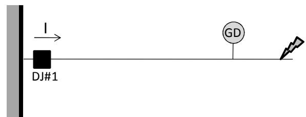
Figura 11. Falha a jusante da GD
