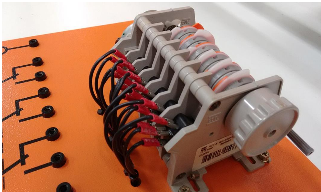
Figura 3.9. Temporizador cíclico de seis acionadores Coel RCT B11 1139 095.
