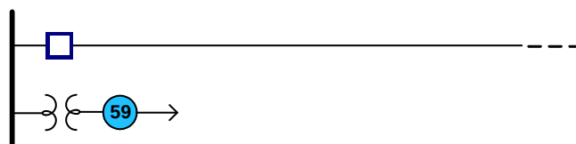
Figura E.29 – Relé de Sobre Tensão no sistema de potência
