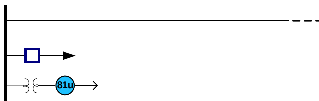
Figura E.37 – Relé de Sub Frequência no sistema de potência
