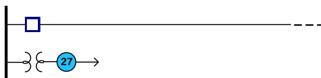
Figura E.12 – Relé de Sub Tensão no sistema de potência
