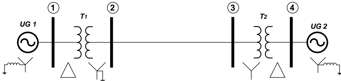
Figura 12 – Diagrama unifilar do sistema do Exemplo 12.4 do Stevenson
