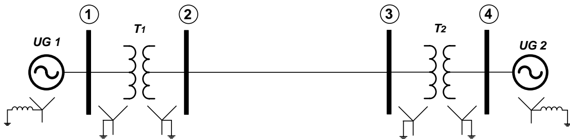
Figura 7 – Diagrama unifilar do sistema do Exemplo 12.2 do Stevenson
