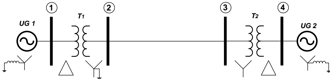
Figura 1 – Diagrama unifilar do sistema do Exemplo 12.1 do Stevenson
