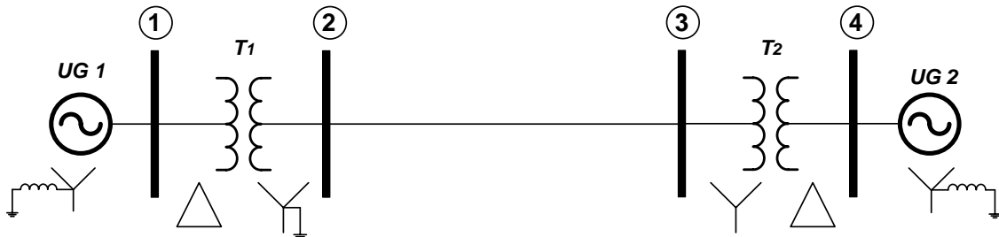
Figura 10 – Diagrama unifilar do sistema do Exemplo 12.3 do Stevenson
